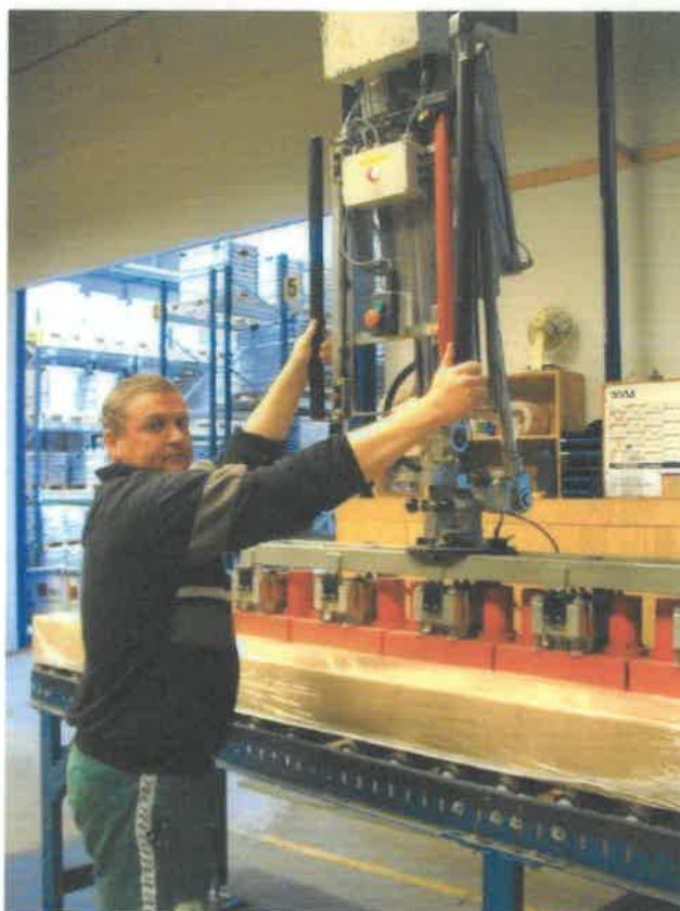
Forkert arbejds højde. Før betjeningspanel længere ned.
