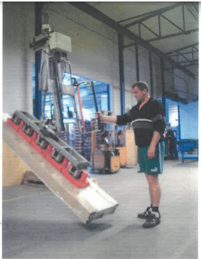
Under kipning til lodret placering er det vigtigt at holde emnet i lav højde.
