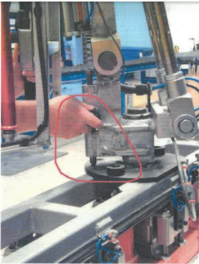
Ved kipning til lodret placering drejes magneten.
