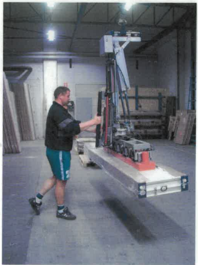
Korrekt arbejdsstilling ved transport. Ingen vrid og tæt på emnet.
