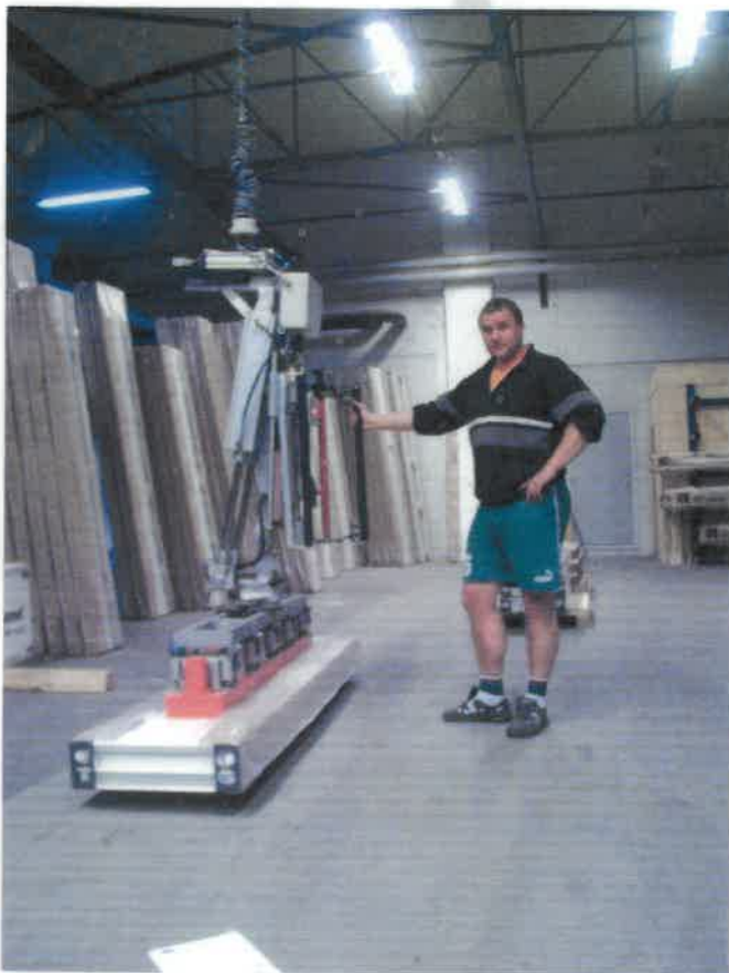
Korrekt lav højde før kipning.
