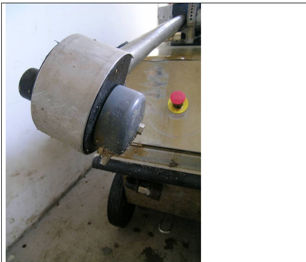
10: Svirvlen i spulehovedet er iflg. Skiold en sliddel, som holder ca. et år ved normal drift. Svirvlen koster ca. 500 kr. og kan skiftes af brugeren på ca. 15 min.
