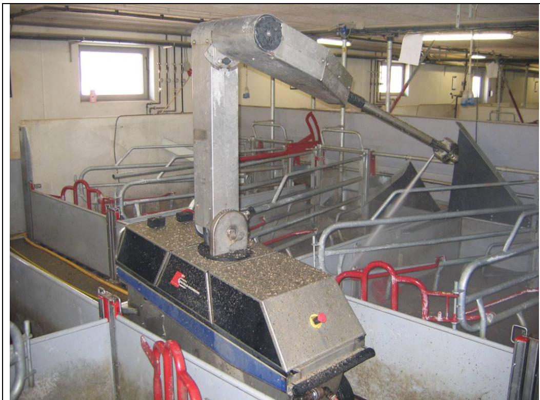
7. Skiold vaskerobot med indbygget højtryksrenser fra Gerni.
