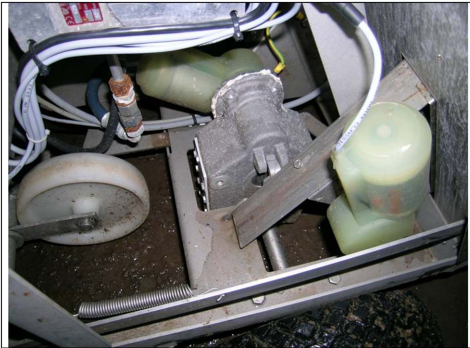
2: Teknikken er godt afskærmet, og adgangsforholdene tilfredsstillende. Materialerne er generelt velvalgte og der var ikke mange rustne/tærede dele.
