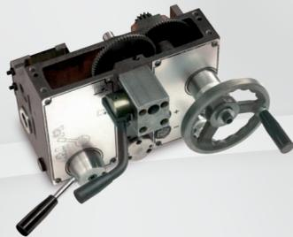
La carcasa del delantal está totalmente cerrada. Hay un dispositivo de seguridad que impide que actúen simultáneamente los mecanismos de avances y roscas.
